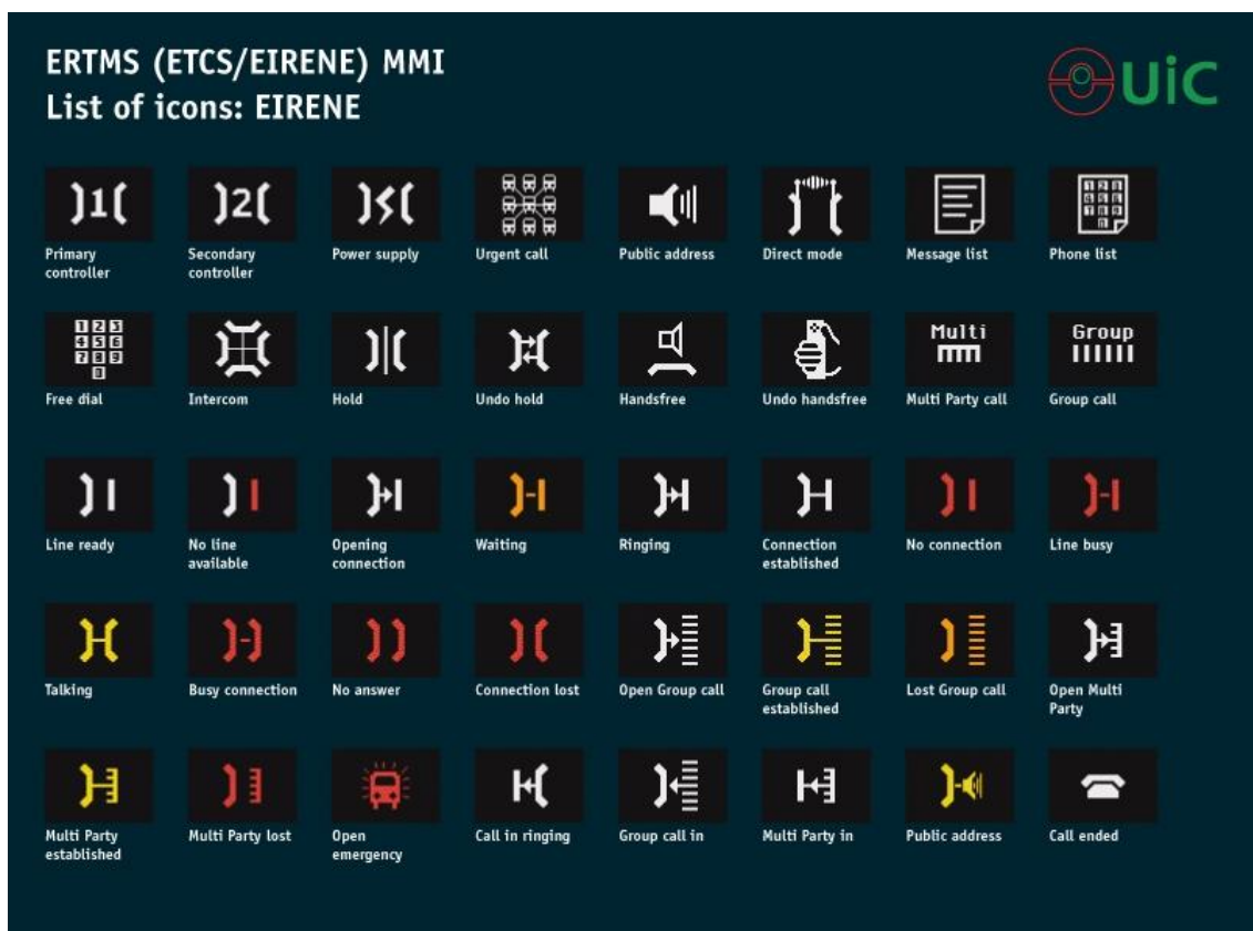
Fig. 5.5: Tabla de iconos y su significado utilizados en la consola de mensajes
