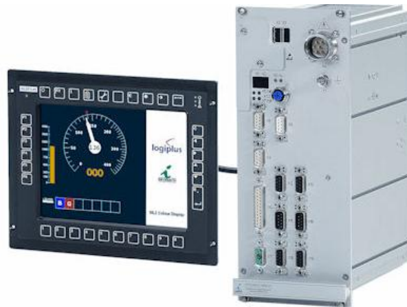
Fig. 4.37: Pantalla y módulo que conforman el DMI
