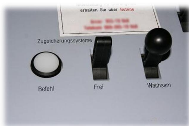
Fig. 3.2: Pulsadores del sistema INDUSI
