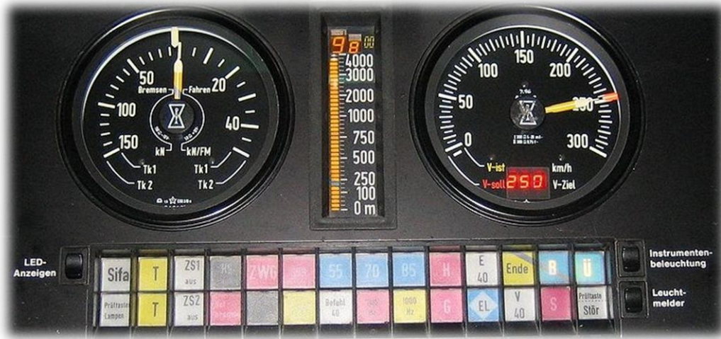
Fig. 3.11: Interface humana (DMI) del sistema LZB
