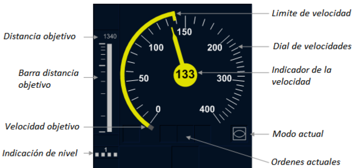
Fig. 4.42: Componentes del velocímetro
