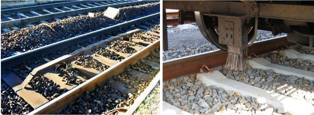
Fig 3.6: Barra en vía y frotador embarcado en el tren para Crocodrile
