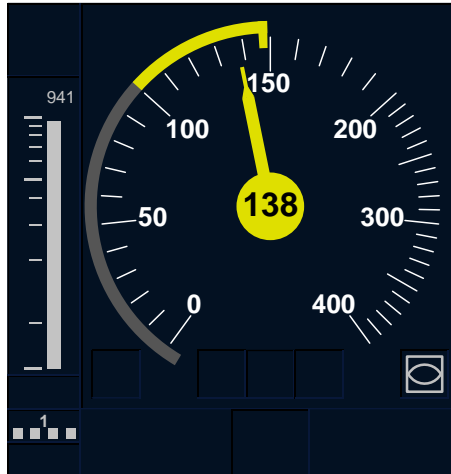
Fig. 4.45: Estado del velocímetro en caso de superar la velocidad límite
