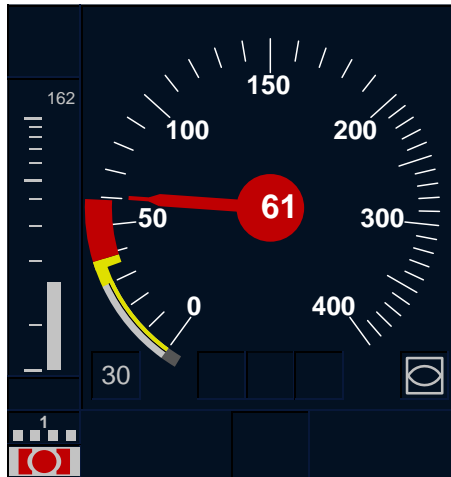
Fig. 4.47: Estado del velocímetro si se supera la velocidad máxima de seguridad
