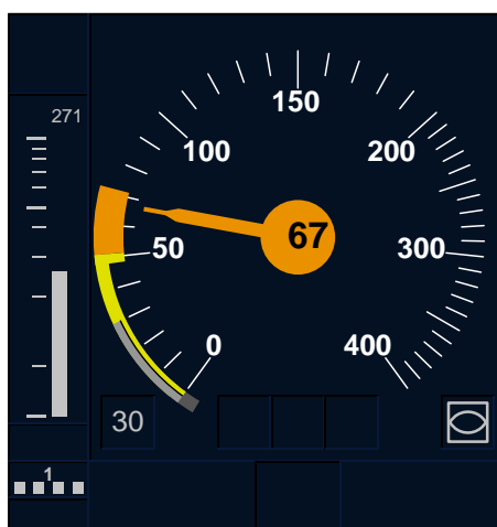
Fig. 4.46: Estado del velocímetro en caso de superar la velocidad de supervisión
