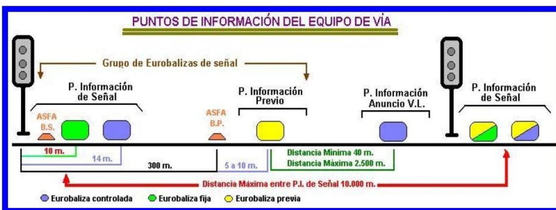
Fig. 4.25: Subsistema de vía en líneas equipadas con ERTMS/ETCS Nivel 1 y con ASFA como sistema de respaldo
