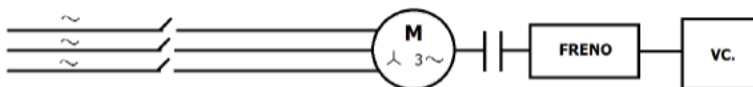
Figura 7.4: Banco de ensayos cuyo motor es alimentado directamente de la red.
