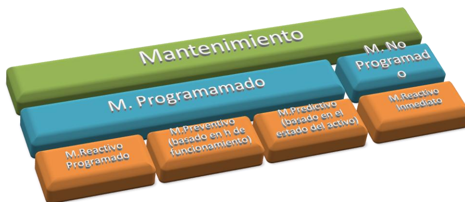
Figura 4.2: Intervenciones de mantenimiento.
