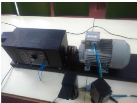
Figura 7.6: Motor de inducción nº11 de nuestro banco de ensayos.
