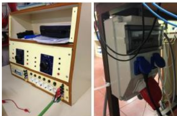
Figura 7.3: Fuente de alimentación a la izquierda y caja de conexiones a la derecha
