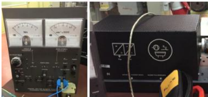
Figura 7.7: Motor Controlador de freno a la izquierda y freno de polvo magnético a la derecha.
