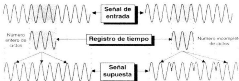
Figura 5.8: Distorsión de la señal de entrada.
