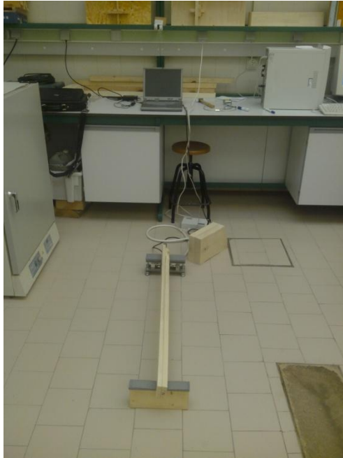
Figura 4.8. Equipo de vibraciones inducidas PLG en funcionamiento
