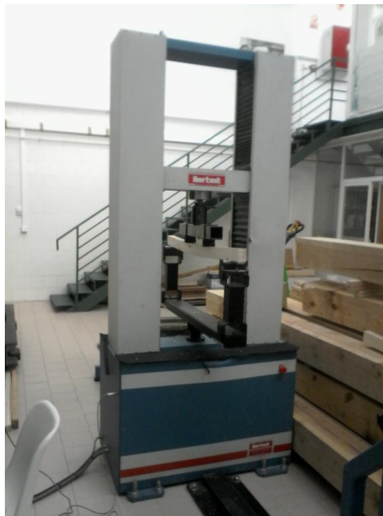
Figura 4.9. Máquina universal de ensayos Ibertest ELIB-100W
