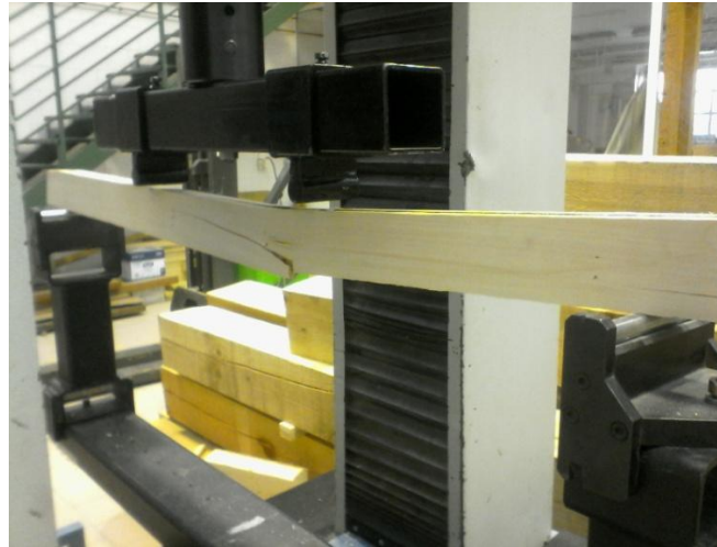
Figura 4.36. Ensayo de flexión, rotura de una viga dúo reforzada
