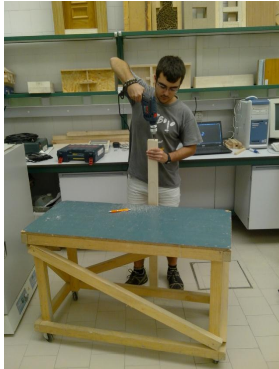
Figura 4.29. Realización de los orificios para introducir las puntas de los palpadores en la realización del ensayo del sylvatest Trio
