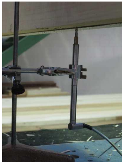
Figura 4.34. Instalación del sensor de deformación
