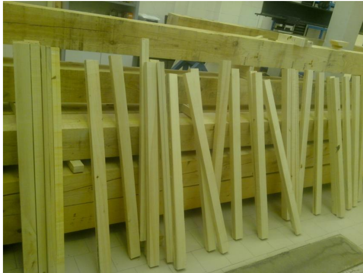
Figura 4. 1. Lote de probetas dúo reforzadas con fibra de carbono
