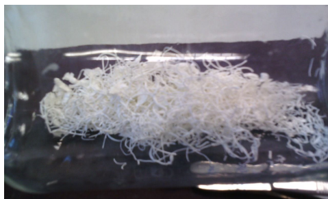
Figura 4: Filamentos del polímero antes de su deposición en película.
