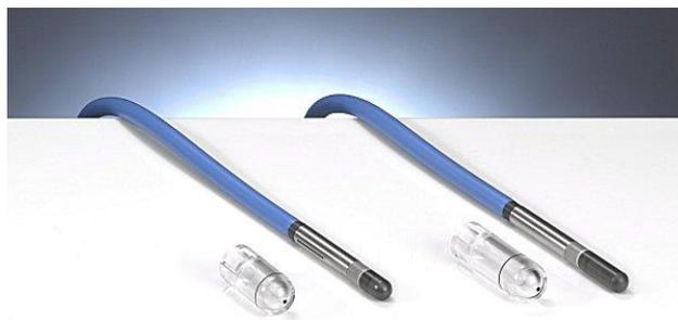
**Figura 6. 8 Cámara de ionización**
