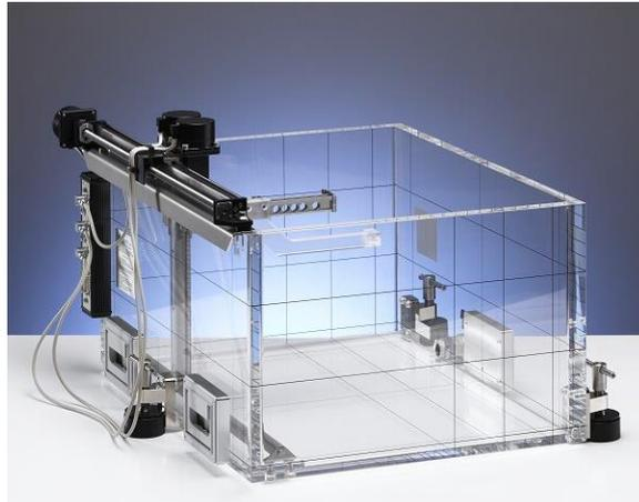
**Figura 6. 10** Cuba de agua para calibrar el haz de radiación
