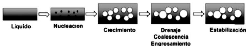
Figura 7. Etapas del proceso de espumado en materiales poliméricos.
