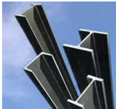
Figura 1.1.2 - Perfiles de acero laminados.
