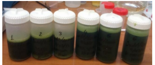
Ilustración 2: Botes de centrifugación para separar el líquido y el sólido de las muestras
