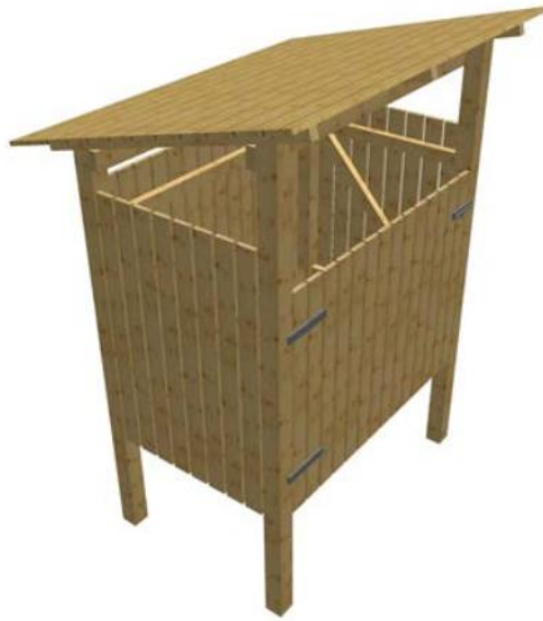
Figura 6: Cubrecontenedores de tipo sencillo
