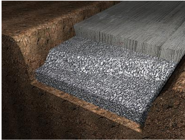
Figura 6.5: Encachado en caja
