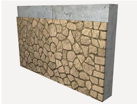
Figura 6.10.1: revestimiento de piedra irregular
