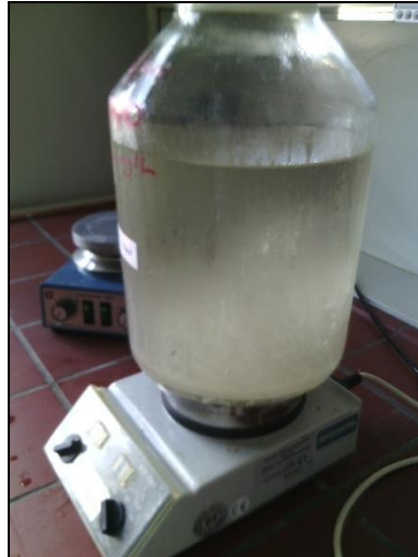
Ilustración 40. Recipiente para la preparación del agua residual artificial
