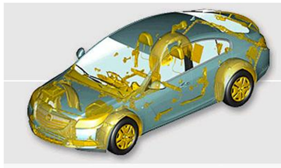
Figura 47: Piezas fabricadas a partir de plástico reciclado en el Opel Insignia. Fuente: Opel.
