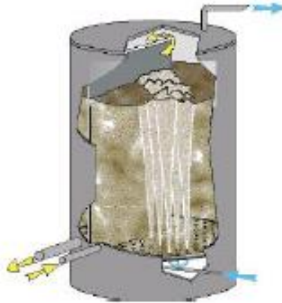
Figura 4. Digestor del proceso VALORGA
