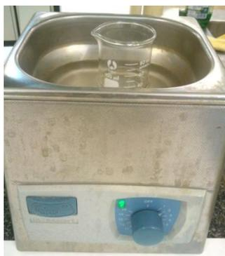
*Figura 3.26. Dispositivo de ultrasonidos Selecta Ultrasons*
