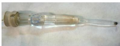
Figura 3.18. Electrodo de referencia Ag/AgCl/KCl 3M
