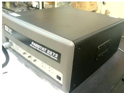
*Figura 3.22. Potenciostato/Galvanostato PARStat 2273*
