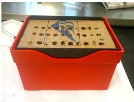
Figura 3.13. Soporte de mantenimiento vertical de electrodos
