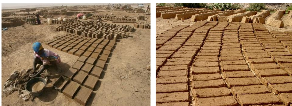
Figura 17 y 18. Bloques de adobe y patios de sacado. Fuente: https://500generaciones.wordpress.com/2009/11/23/ano-5200-ac-ladrillos-de-adobe/
