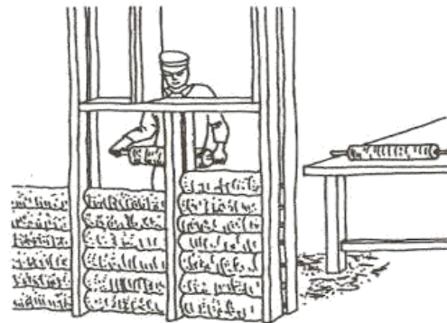
Figuras 2 y 3. Casa tipo fachwerk. Entramado y relleno con barro y paja. Fuente: http://mastersuniversitaris.upc.edu/tecnologiaarquitectura/tesis/Bohn.pdf
