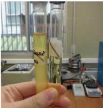
Figura 14. Tubo Hungate con microorganismo en el medio de mantenimiento (izquierda), tubo Hungate con medio de mantenimiento (derecha).
