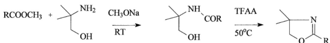
Figura 6. Proceso de formación de las 4,4 dimetiloxazolinas: en primer lugar al tratar los ésteres metílicos con el AMP y el metóxido de sodio se forman las 2 acilmetilpropanolamidas, y posteriormente el anhídrido trifluoroacético promociona el cierre del ciclo dando lugar a las DMOX.
