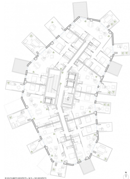
48. Los voladizos y distintas orientaciones de la planta de forma troncoidal se ven el plano superior. Planta extraída de la web www.oxoarch.com
