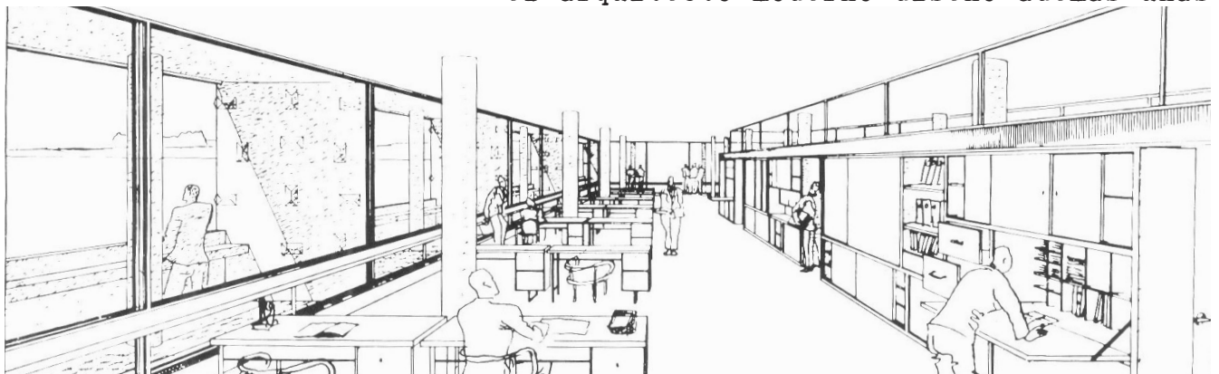
70. Dentro de esta vista interior realizada por Le Corbusier las diversas logias evitan que la fuerte luz solar dificulte el trabajo en las oficinas. Boesiger, W. Obras completas 1938-1946 .
