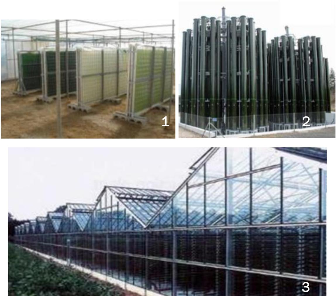
Figura 7. Fotobiorreactores cerrados: plano (1) y tubulares (2 y 3).
