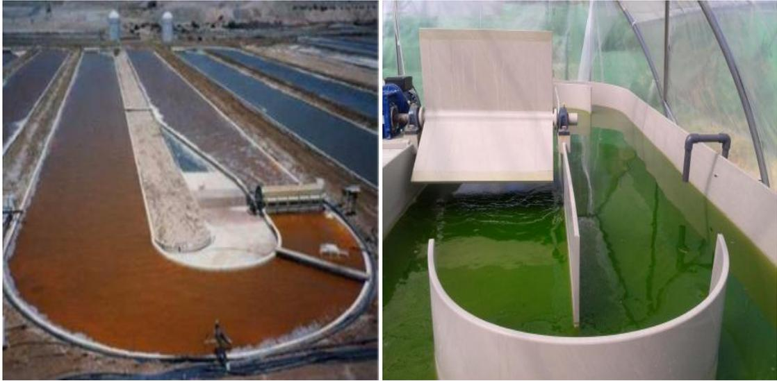
Figura 6. Fotobiorreactores abiertos.
