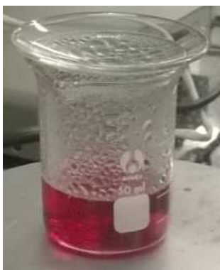
Figura 16: Disolución de la sal de cloruro de oro (III) en agua. Aunque al principio la disolución es amarilla, según se van formando las nanopartículas adquiere un color rojizo.
