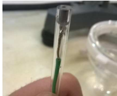
Figura 26: Electrodo con sustrato de platino. En la parte superior se puede observar la película de polipirrol, de color negro.
