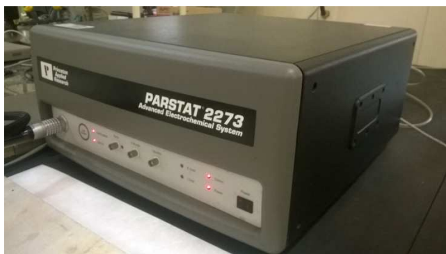
Figura 22: Uno de los potenciostatos del laboratorio de química inorgánica de la Escuela de Ingenierías Industriales de Valladolid.
