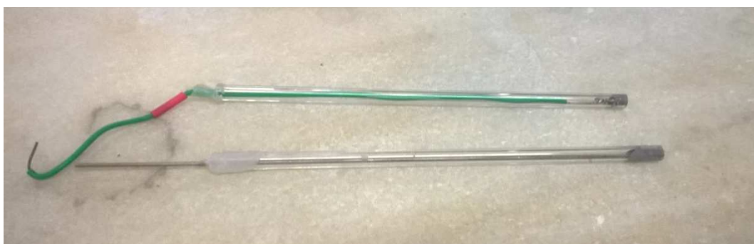
Figura 20: Electrodo con Nural sellando el extremo del tubo (derecha). El electrodo de platino (superior) está soldado a un cable de cobre mientras que el electrodo inferior está constituido por un hilo de acero inoxidable.
