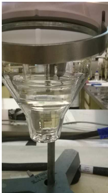
Figura 24: Electrodos sumergidos en una disolución de pirrol: De izquierda a derecha, el electrodo de referencia, el de trabajo, y el contraelectrodo.
