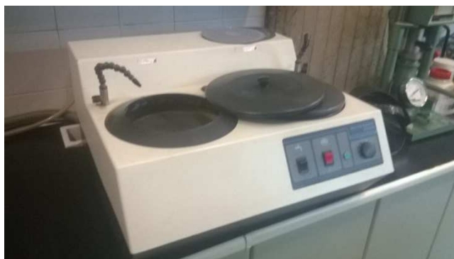
Figura 21: Pulidora utilizada en este trabajo. Permite regular la velocidad de giro del paño.
