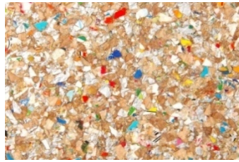
Ilustración 11. Detalle de superficie tectán. Fuente. http://www.proyecta56.com/tectan-el-conglomerado-resultante-del-reciclado-de-un-tetrabrik/
