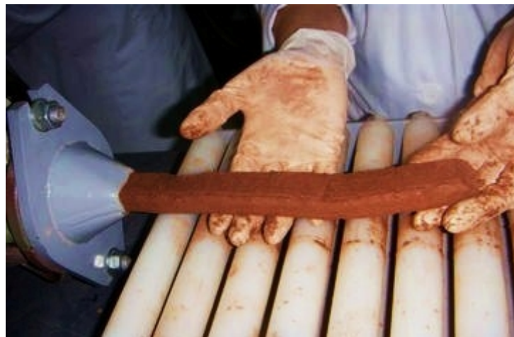
Ilustración 32. Ladrillos de papel. Fuente. https://www.amarilloverdeyazul.com/2013/04/la-universidad-de-jaen-desarrolla-ladrillos-ecologicos-reciclando-residuos-de-celulosa-procedentes-de-la-fabricacion-de-papel-reciclado/
