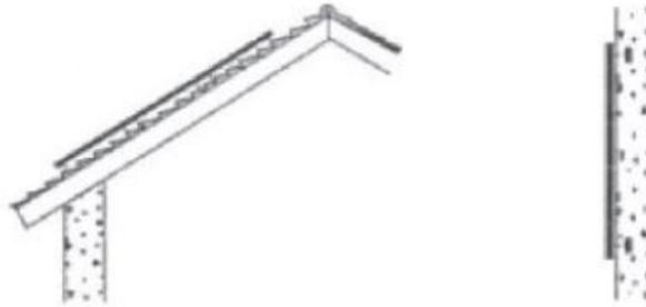
Fig 10. Módulos fotovoltaicos superpuestos en tejado y fachada
