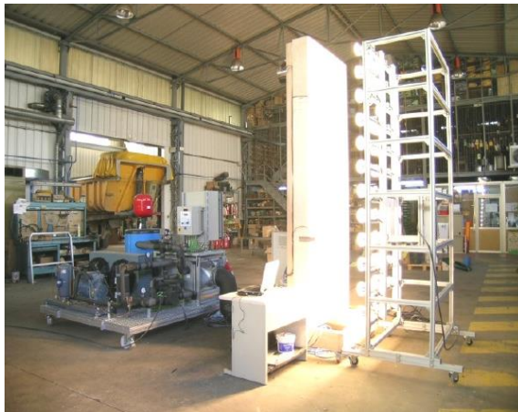
FIGURA 29. Prototipo de captador solar de aire para la fachada Sur y sección tipo con captador solar. Fuente: memoria del proyecto ENVITE.
