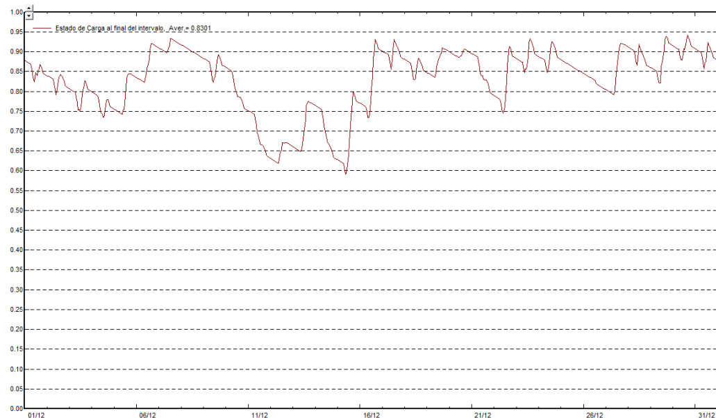
Estado de carga para el mes de diciembre antes de reducir los consumos.
