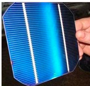
Célula monocristalina. Fuente: www.directindustry.es/
