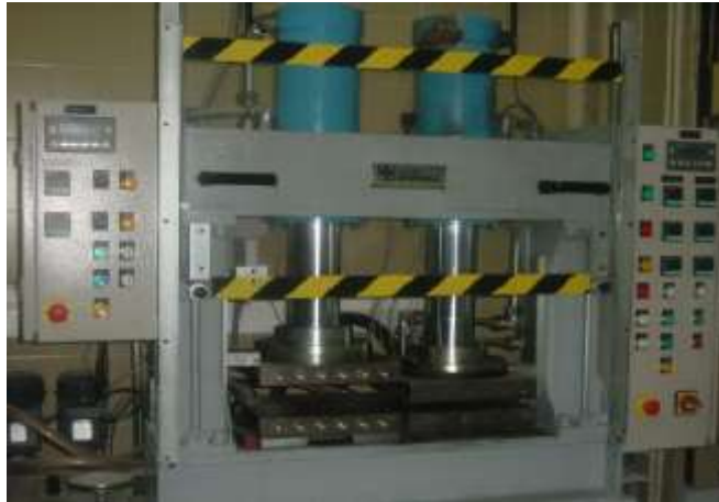
Figura 4.1. – Prensa de platos fríos y calientes del laboratorio CellMat.
