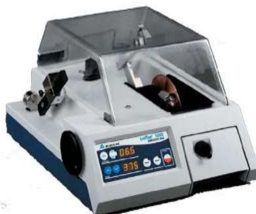
Figura 4.6. – Cortadora de precisión utilizada para que las muestras tengan las dimensiones adecuadas en los ensayos de acústica.
