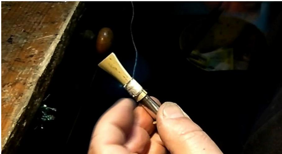
Figura 27. Detalle del atado de las palas al tudel<sup>101</sup>
