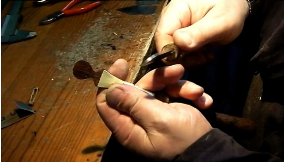
Figura 29. Detalle del igualado de las paredes con navaja de desgaste.<sup>103</sup>
