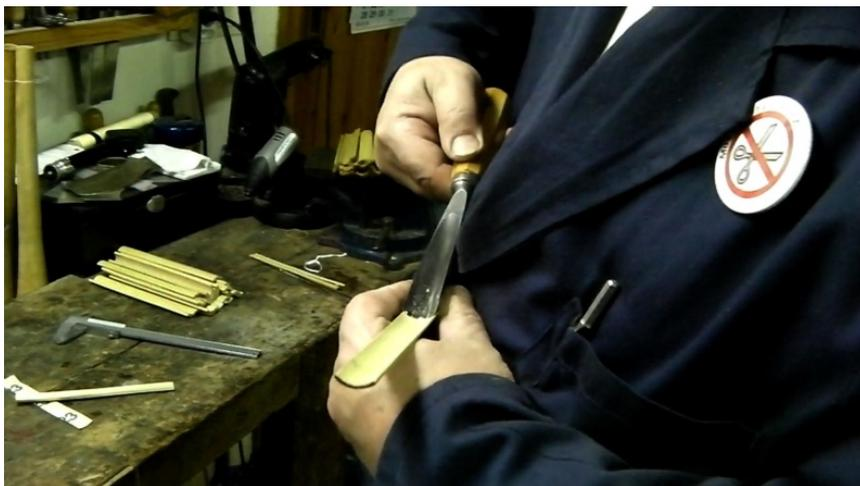
Figura 23. Terminado manual del rebaje de las láminas.<sup>95</sup>
