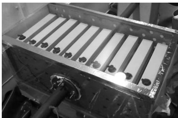
Figura 2.9. Diseño final del prototipo evaporativo. (Realizado por el equipo Urcomante)
