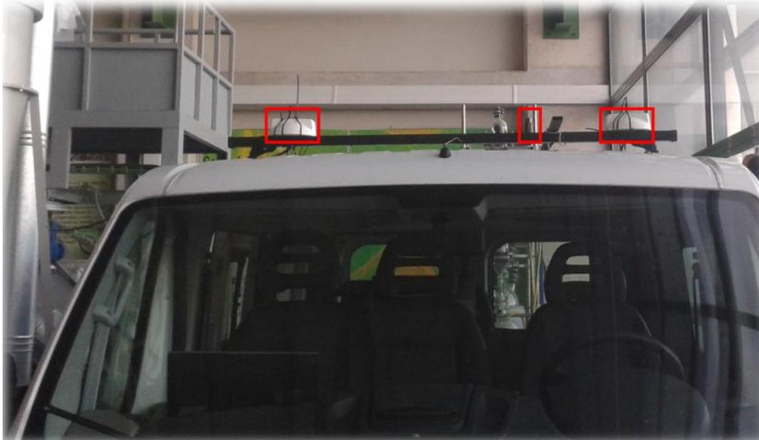
Figura 4.1. Imagen de la furgoneta especializada usada en las pruebas de campo, en la que se puede apreciar la situación de las difentes antenas
