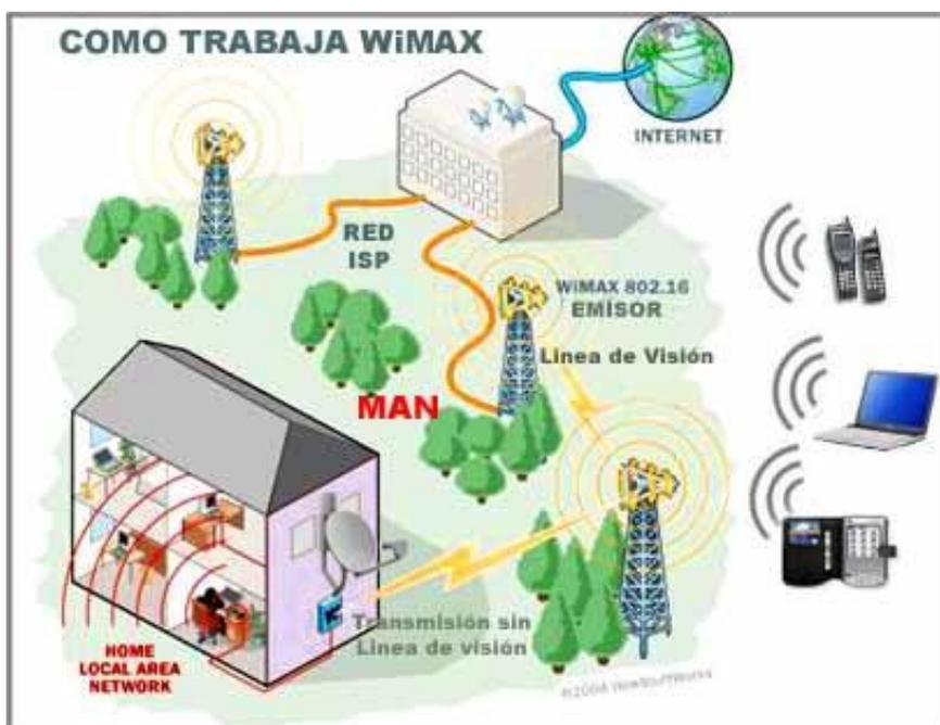
Figura 2.1. Funcionamiento del *WiMax*.
