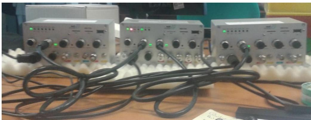
Figura 2.10. Conexión *Ethernet* entre los 3 dispositivos *router*.
