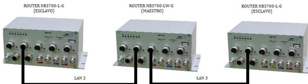
Figura 2.8. Conexión *Ethernet* de los *routers*.
