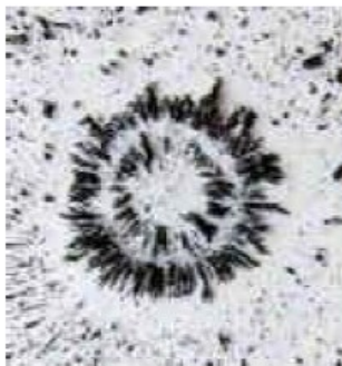
Líneas de campo en un imán anular extraído de un auricular
