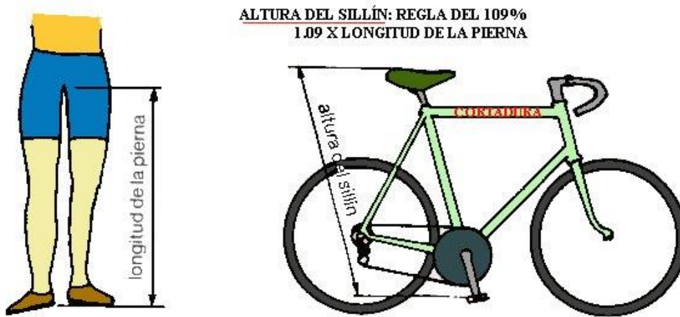
(35) Forma de medir tallas en bicicleta (similar en moniciclos).
