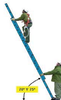
Colocación correcta de la escalera.
