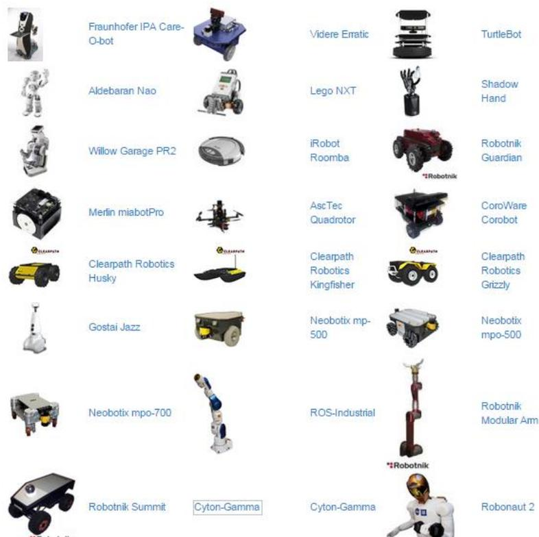
Figura 4.2. Ejemplos de robots que incorporan ROS [24].
