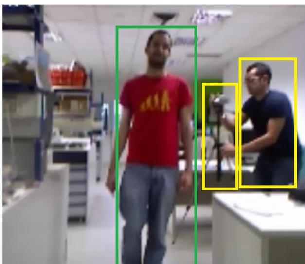
Figura 7.16. Falso positivo en la cámara.
