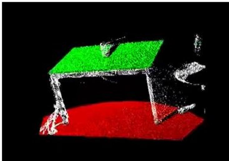
Figura 4.4. Tratamiento de una nube de puntos con PCL.
