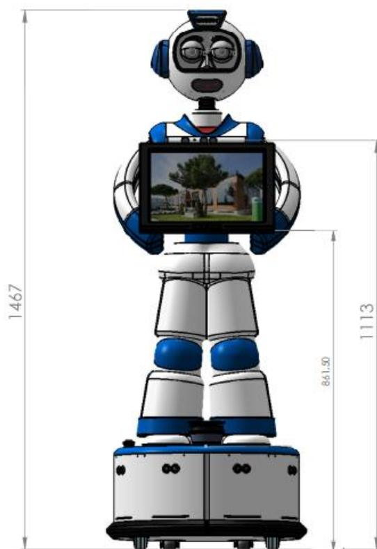
Figura 7.7. Medidas de las alturas de Kinect en Sacarino 2.
