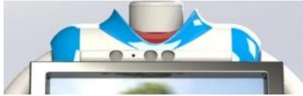
Figura 5.4. Kinect incorporado en el chasis del robot.
