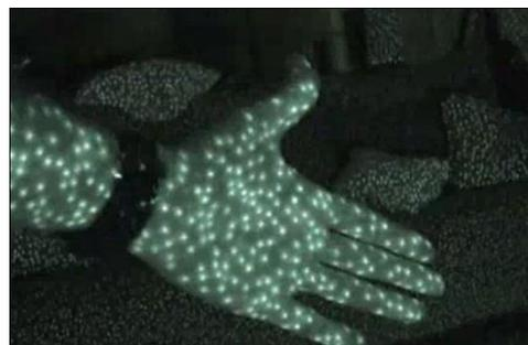
Figura 3.8. Puntos de luz proyectados por el sensor IR.
