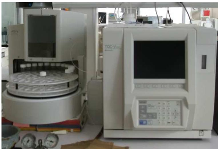
*Figure 4.6. TOC Analyzer Shimadzu.*
