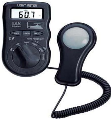
El luxómetro es un instrumento de medición que nos permite medir niveles de iluminancia real y no subjetiva del ambiente y ello de forma muy simple y rápida. Su unidad de medida es el Lux (lx). A través de una célula fotoeléctrica, capta la luz y lo que hace es convertirla en impulsos eléctricos. Dichos impulsos son interpretados y representados en una aguja con la correspondiente escala de luxes.
