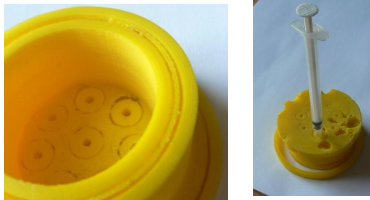
Imagen 182. Detalle de la falta de adhesión y material en la pared (izquierda) y pieza en la posición teórica de trabajo con un soporte material del sensor de muestra (derecha)
