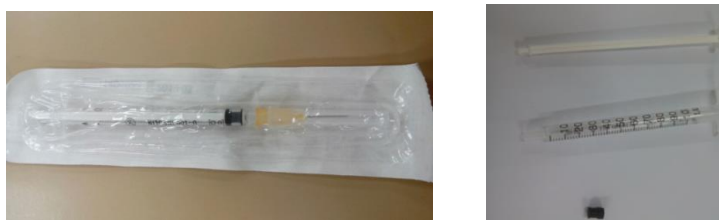
Imagen 37. Jeringuilla de PVC que se utiliza en la fabricación de sensores (izquierda), elementos constituyentes de la jeringuilla (derecha)
