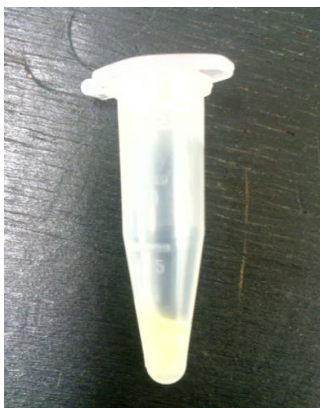
Imagen 48. Eppendorf preparado con Enzima Glucosa Oxidasa para ser conservado y utilizado en el futuro en la fabricación de biosensores
