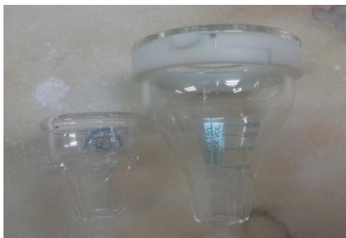
Imagen 61. Celda utilizada para el análisis de analitos durante el proyecto, de 25 ml (izquierda) y de 50 ml (derecha)
