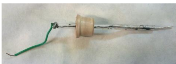
Imagen 59. Contraelectrodo de Platino utilizado en el desarrollo del proyecto
