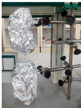
Imagen 46. Proceso de reposo de los electrodos en posición vertical mediante paquetes de papel de aluminio.
