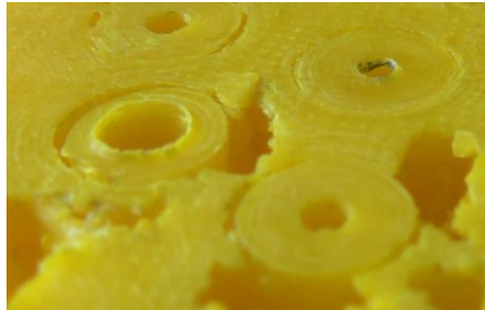
Imagen 180. Detalle de los orificios para la localización de los sensores
