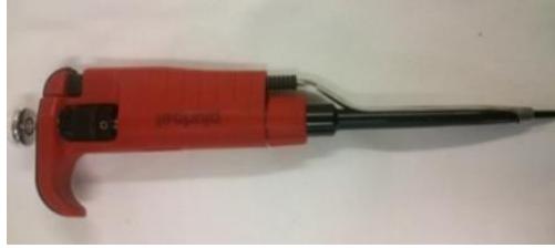
Imagen 50. Micropipeta de 200 \mu l utilizada para el proceso de modificación de sensores
