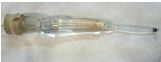
Imagen 58. Electrodo de Referencia utilizado en el proyecto ya montado en su totalidad
