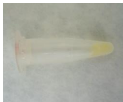
Imagen 51. Enzima homogeneizada preparada para ser utilizada en la deposición en los electrodos durante el proceso de adsorción
