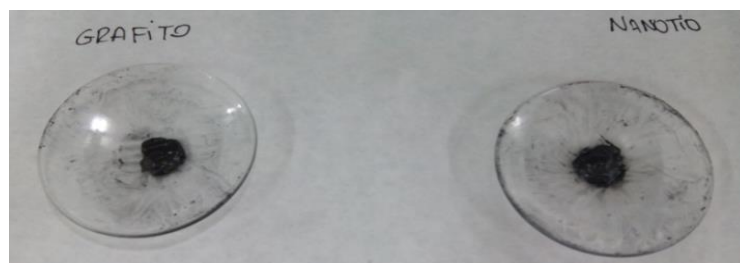
Imagen 36. Diferencia de aspectos entre la pasta de nanopartículas de Carbono y la modificada con nanopartículas de TiO_2
