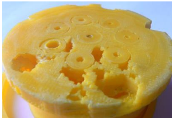
Imagen 181. Detalle de la falta de relleno y descuelgues de la primera impresión
