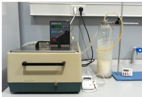
Figura 9b. Equipamiento: baño, viscosímetro y cronómetro
