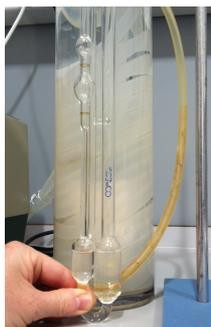
Figura 9a. Viscosímetro capilar
