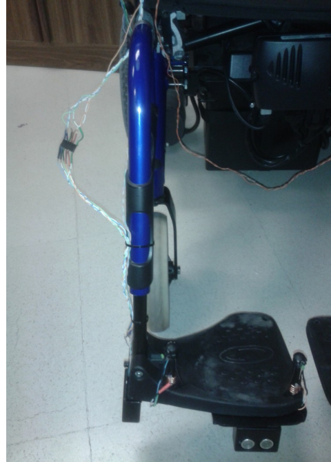
Figura 2-21 y 2-22: Reposapiés derecho e izquierdo con los botones para controlar la silla
