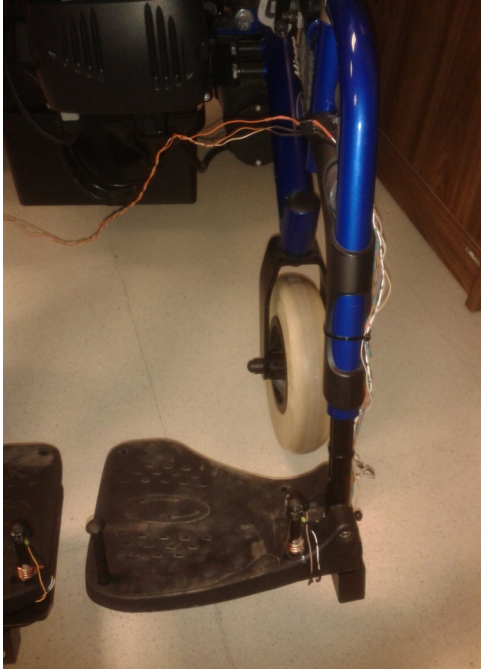
Figura 2-21 y 2-22: Reposapiés derecho e izquierdo con los botones para controlar la silla
