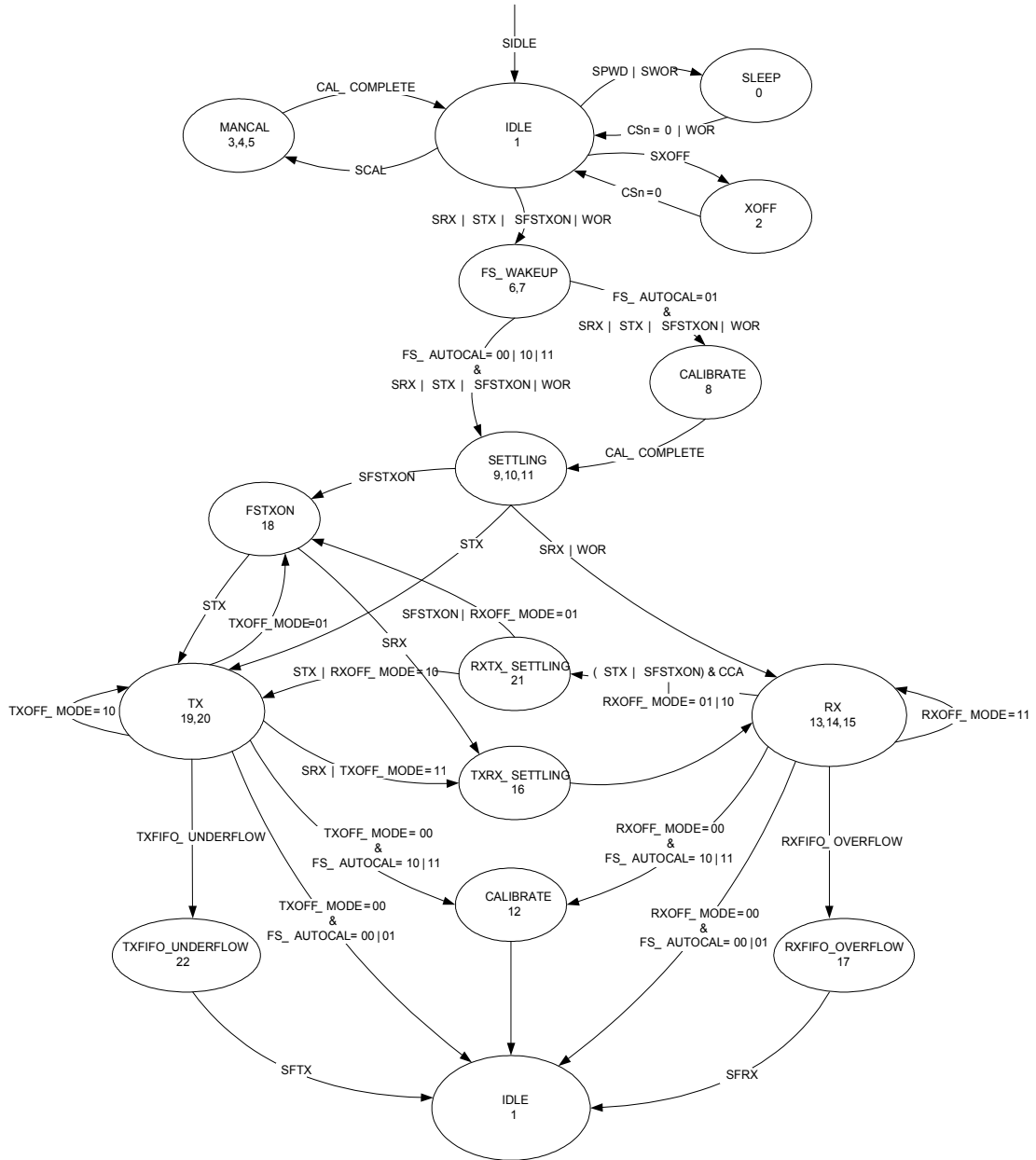
Figura 2.3: Diagrama de estados completo del integrado CC2500
