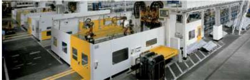
*Ilustración 20 Línea integral para estampación en caliente.*
