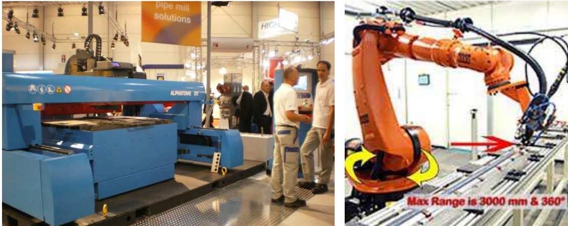
Ilustración 21. Izq Laser sobre portal. Drch laser sobre robot de 6 ejes.
