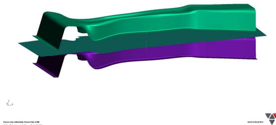
**Ilustración 31.** Disposición de los troqueles previa a la estampación. El troquel inferior se denomina Die y el superior Punch. El cual tiene una ampliación (offset) de 2 mm.
