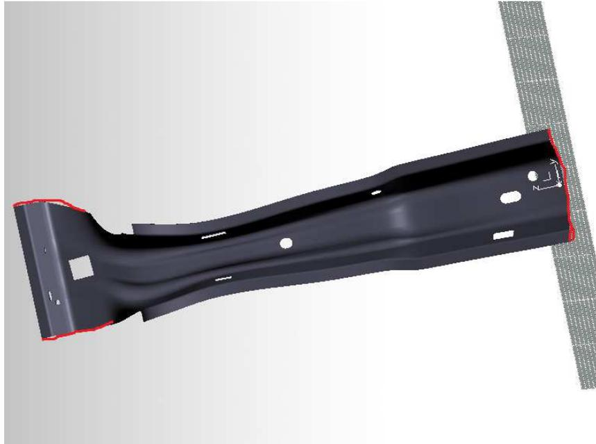
**Ilustración 46.** Geometrías exteriores cortadas por laser para asegurar buenas calidad y tolerancias.
