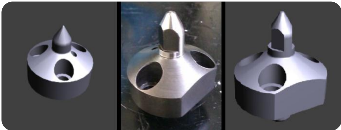
Figura 61: Centrador cilíndrico modelo CAD, centrador oblongo y su modelo CAD
