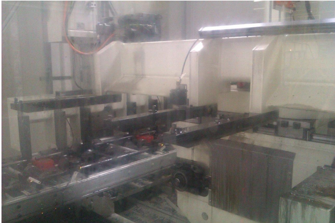
Figura 47: Cargador del centro de mecanizado
