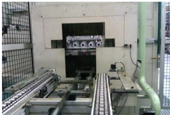
Figura 38: Poka-Yoke entrada culata a lavadora
