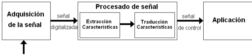
Figura 2.4: Esquema de las etapas de tratamiento de una señal en un BCI [17].
