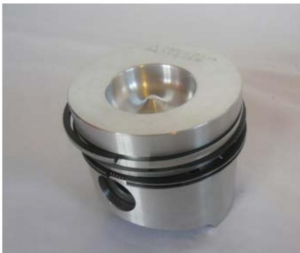
Figura 3.5. Detalle de la cámara de la superficie del pistón labrada para mejorar la combustión.
