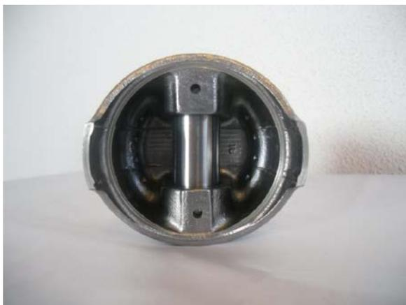
Figura 3.6. Vista de planta inferior del pistón donde pueden verse los conductos de refrigeración y los de lubricación del bulón.
