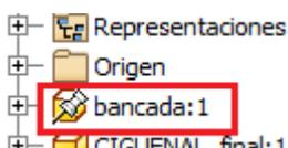
Figura 6.13. Icono de componente 'Fijo' en un ensamblaje.
