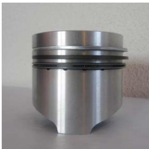
Figura 3.7. Vista lateral del pistón donde se pueden ver tanto los conductos de refrigeración como la forma de la falda del pistón.
