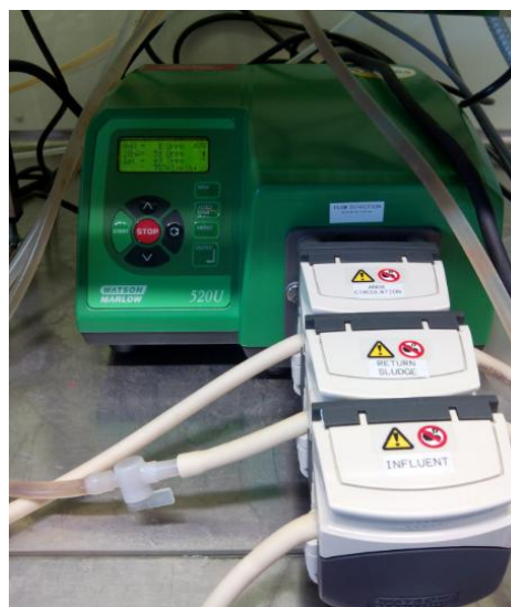
Picture 7. Synthetic water pump (Miguel Rodríguez del Egido, 2015)
