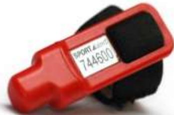
Para utilizar este sistema de control se necesitarán unas estaciones base que se colocan al lado de la baliza. El dispositivo se introducirá en la estación base para marcar el punto encontrado.
