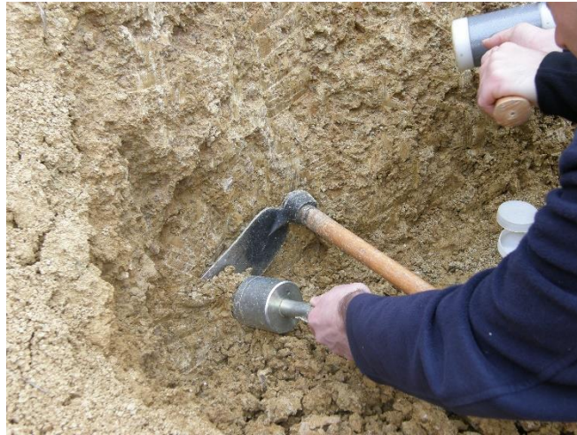
Figura 1. Extracción de muestras inalteradas.
