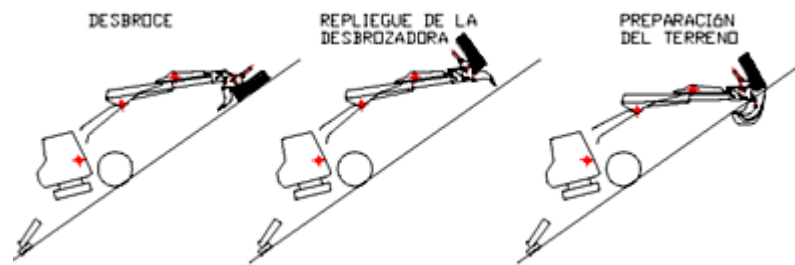
Figura 8. Secuencia de trabajo del cabezal desbrozador – ahoyador. (Fuente: Medioambiental Valledor S.L.)
