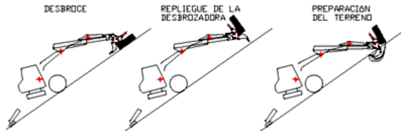
Figura 2. Secuencia de trabajo del cabezal desbrozador – ahoyador. (Fuente: Medioambiental Valledor S.L.)
