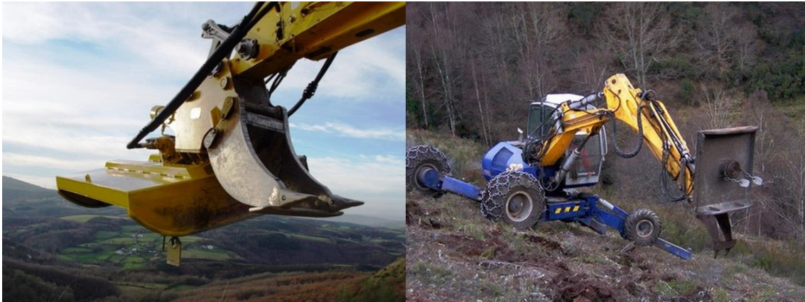
Figura 9. Detalle de un cabezal desbrozador – ahoyador equipado en una retroaraña KAISER S2. (Fuente: Medioambiental Valledor S.L.)
