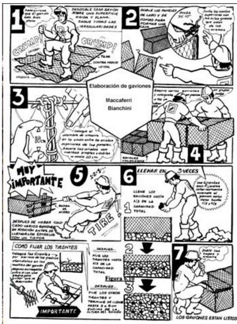
Figura 1. Forma de construcción de los gaviones (Bianchini, 1959).
