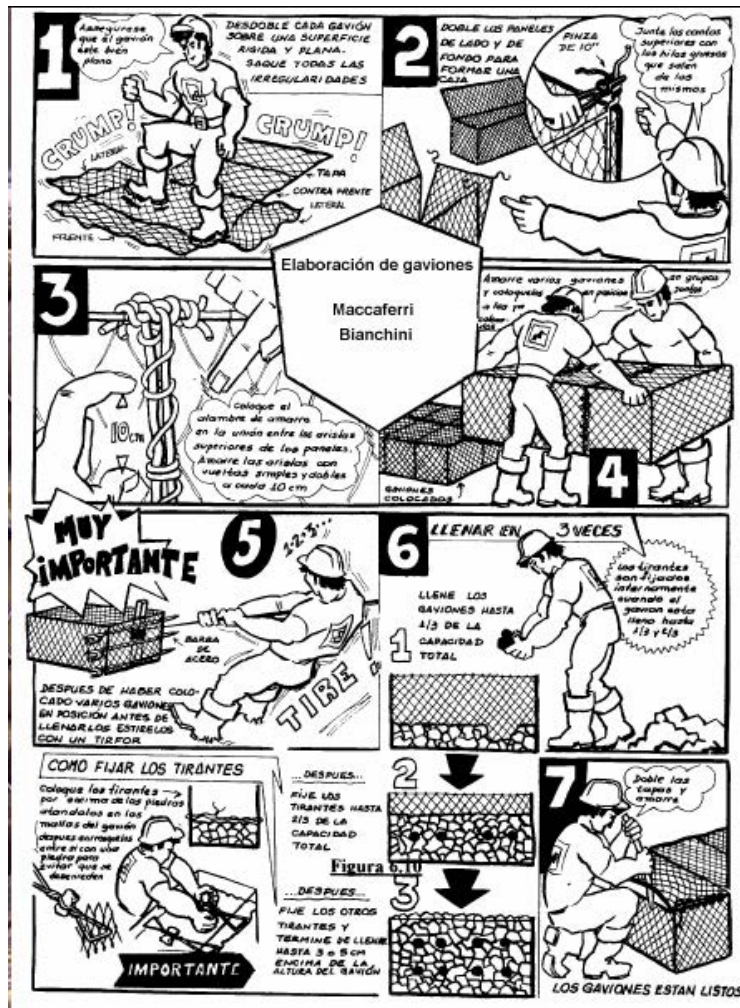
Figura 1. Esquema de montaje de un gavión (Fuente: Bianchini, 1959).
