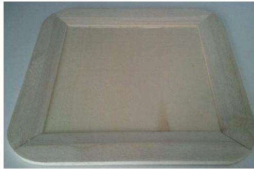
Imagen 11: Prueba 28 de plato cuadrado a partir de chapa base y listones encolados. Vista superior.
