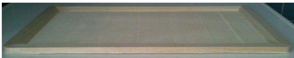
Imagen 16: Prueba 30 de bandeja rectangular a partir de chapa base y listones encolados. Vista lateral.
