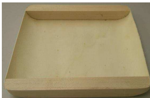
Imagen 13: Prueba 29 de plato cuadrado a partir de chapa base y listones encolados. Vista superior.
