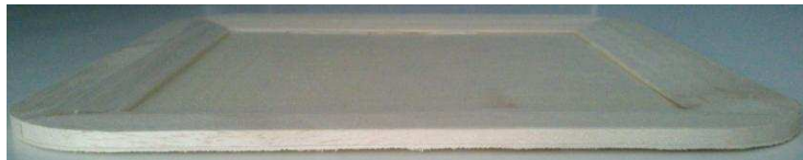
Imagen 12: Prueba 28 de plato cuadrado a partir de chapa base y listones encolados. Vista lateral.
