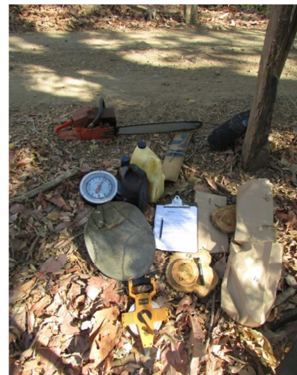
Imagen 36. Materiales utilizados en el muestreo: motosierra, balanza romana, cinta métrica, estadillos, bolsas de papel sin encerar, lápiz, permanente, agua, gasolina...
