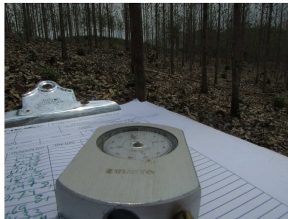
Imagen 53. Medición del rumbo de los árboles de la parcela con la brújula.
