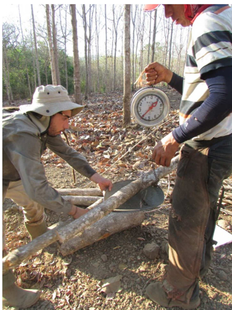
Imagen 26. Pesado de las distintas partes no comerciales del árbol mediante la balanza romana de colgar.
