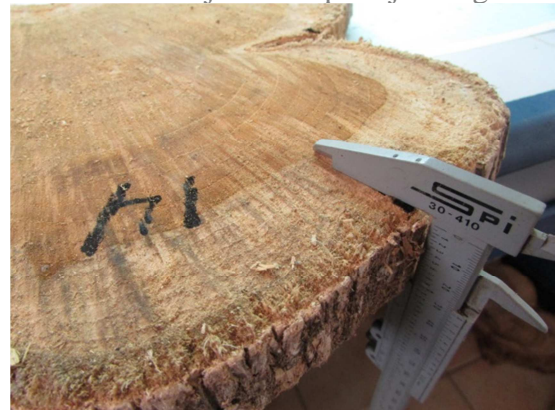
Imagen 40. Medición del espesor de la rodela con escalímetro o pie de rey.
