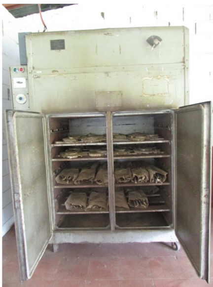
Imagen 41. Alícuotas de ramas en las bolsas de papel sin encerar y rodela base y punta delgada colocadas en el horno para su secado
