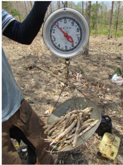
Imagen 28. Recogida y pesado de la alícuota de las ramas para obtención del peso en fresco.
