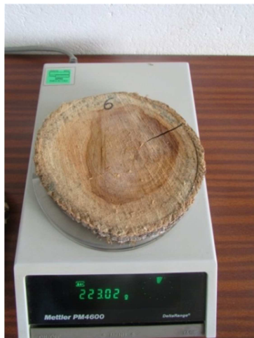
Imagen 45. Pesado de alícuota en punta delgada en la balanza de precisión.
