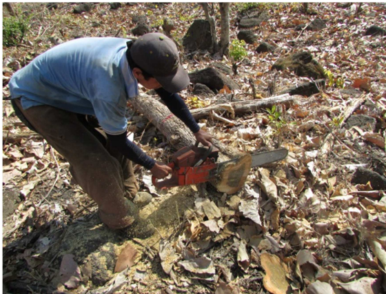
Imagen 33. Corte de las alícuotas o rodelas en base y en punta delgada del fuste comercial.
