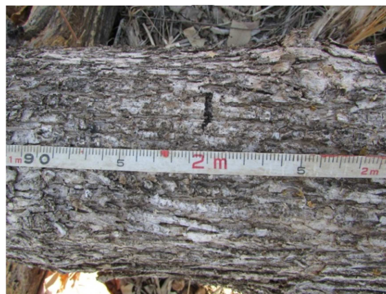
Imagen 32. Marcado de las secciones cada 2 m con rotulador permanente y medición del perímetro en cada una de ellas para estimar su volumen por Smalian.
