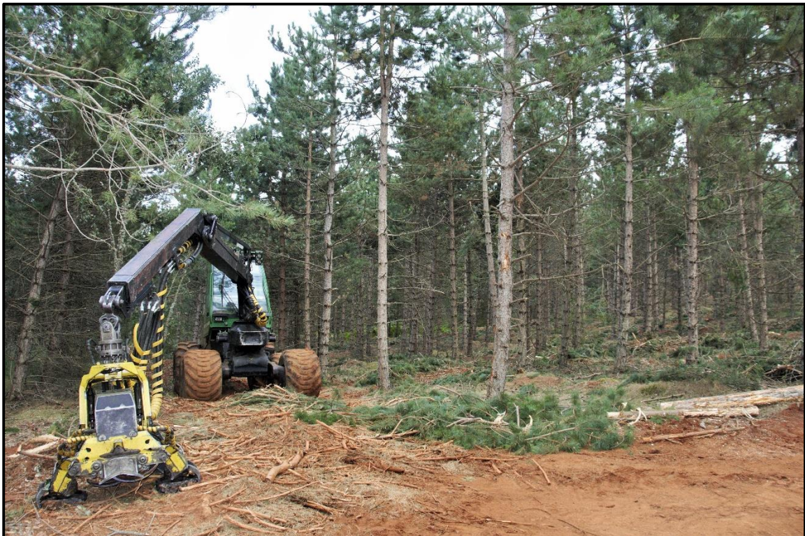
Fotografía 10. Procesadora forestal realizando una primera clara presente en el M.U.P Nº308 perteneciente al Ayuntamiento de Tubilla del Agua.
