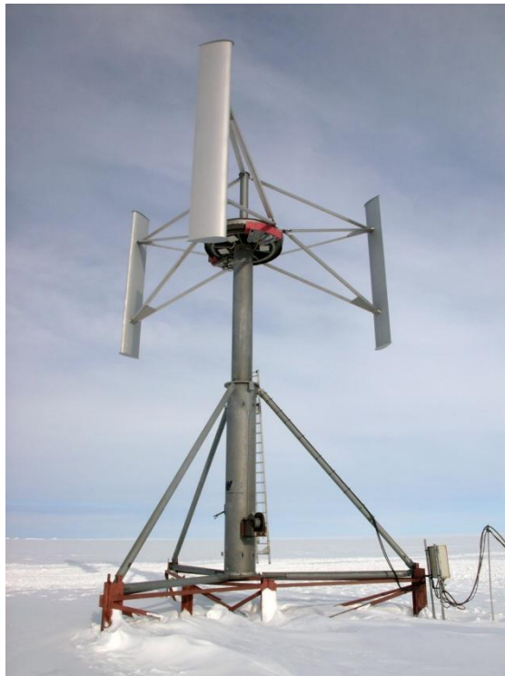
Fig. 2.3: Ejemplo de aerogenerador de eje vertical tipo H-Darrieus, situado en la Antártida [ Wikipedia.org ]
